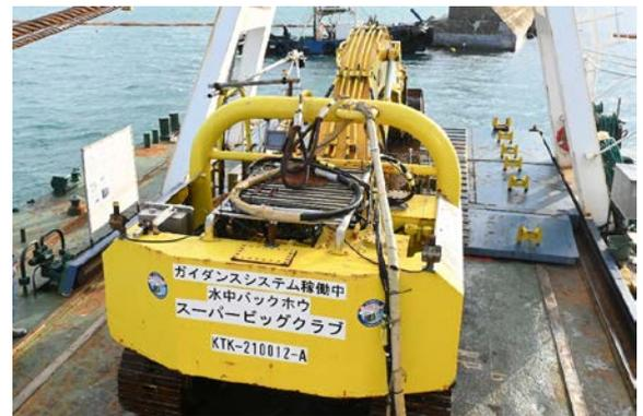
写真2 水中バックホウにシステムを艦装
