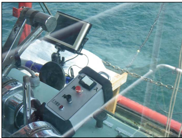
図-4 クレーンオペ室のリモコン装置とモニター
