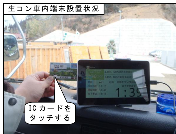
写真-1 生コン車内での端末設置状況
